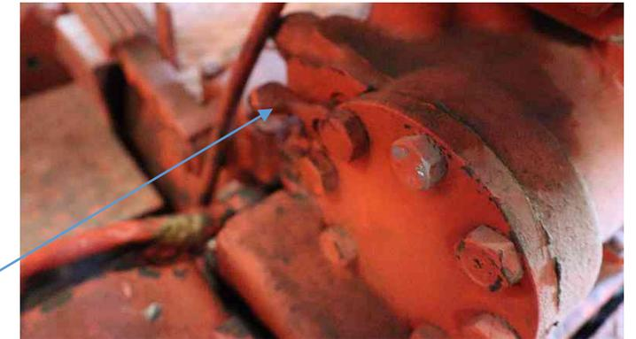
**16)** Dernière recommandation, le levier de relevage doit toujours être en position basse avant d'actionner ce petit levier, moteur à l'arrêt ou en marche.
