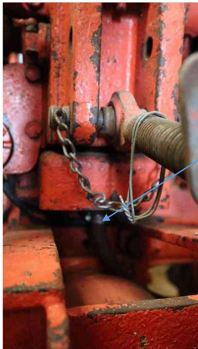
1) vidanger la réserve d'huile par la vis se trouvant sous le bloc relevage à l'arrière sous le dispositif de l'attelage 3 points.
