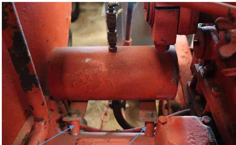
3) Vous pouvez fixer le réservoir sur la trompette avec deux entretoises et deux vis en taraudant à M8, il faut que le trou évent du réservoir soit à la même hauteur que celui qui sera aussi mis en place sur le bouchon de remplissage du bloc de relevage (il vous suffit d'utiliser un graisseur coudé sur lequel vous aurez retiré la bille avec le ressort, pour mettre à chaque endroit)
