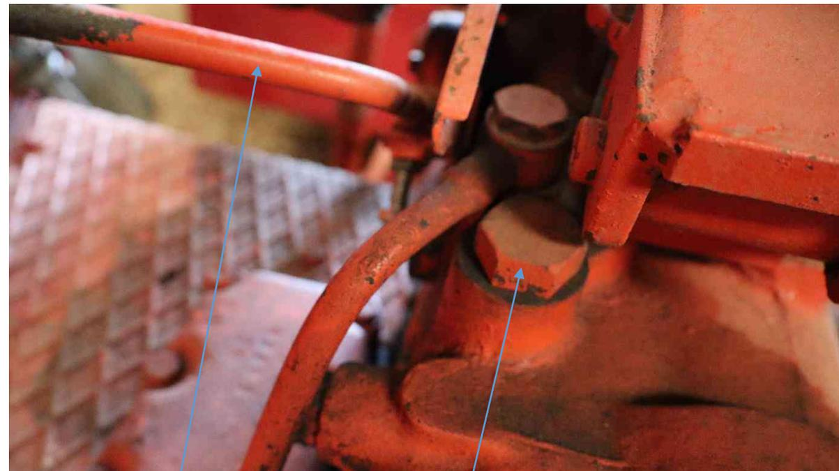
**5)** Mettre le levier de commande de relevage en position basse.
