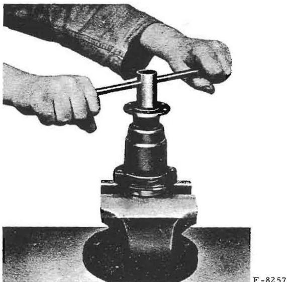
Fig. 29. - Démontage de la bride d'accouplement.
