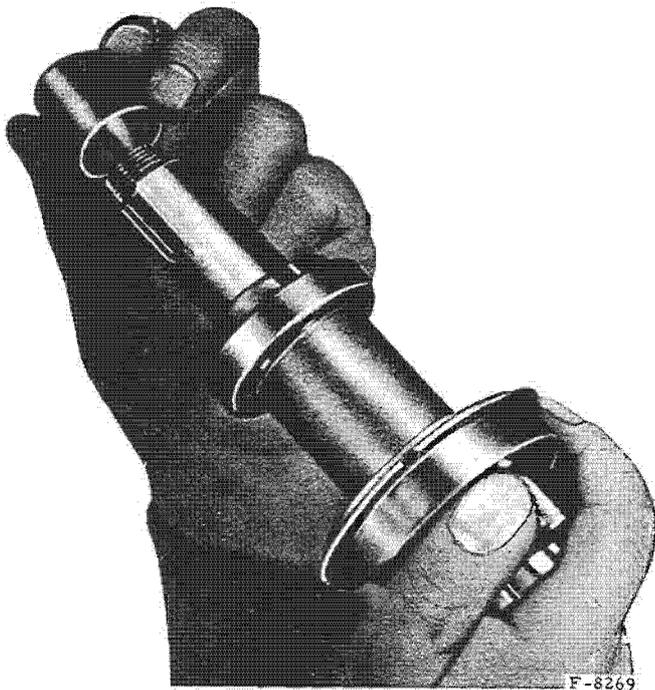
Fig. 53. - Manchon de protection du joint.
