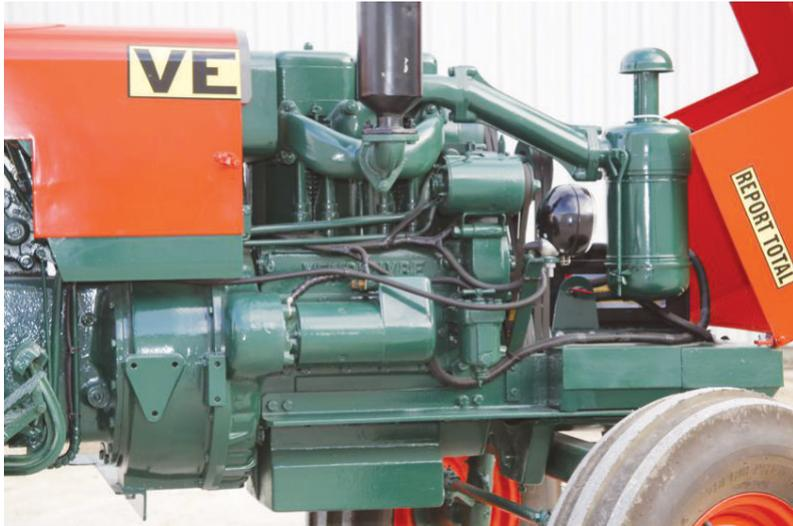
**Le bicylindre Diesel du Vendeuvre BL 335 atteste d'une cylindrée de 2680 cm<sup>3</sup>. De conception simple, cette mécanique est aisée d'entretien. Sur cette vue, nous retrouvons, en avant du moteur, le filtre à air à bain d'huile. La dynamo domine sur le filtre à carburant. Le démarreur est disposé sur le côté droit du moteur, à l'extrémité arrière du bloc.**
