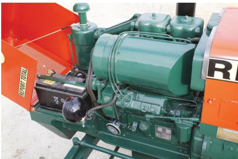
**Le moteur du BL 335 est refroidi par air. Cette vue côté gauche met en exergue la turbine de refroidissement moteur. Cette dernière devance le réservoir de carburant et domine la pompe à injection.**
