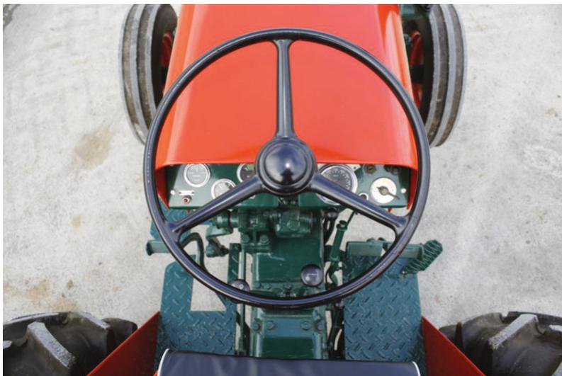
Le BL 335 est équipé d'un volant à trois branches en Bakélite noire. Peinte en vert foncé, la planche de bord est ultra complète. Elle dispose d'une instrumentation Jaeger. Sur la partie gauche de celle-ci, nous retrouvons trois cadrans : un ampèremètre, une jauge de carburant et un indicateur de température d'huile. On notera qu'un témoin de pression d'huile est disposé en bas à gauche de la planche.
